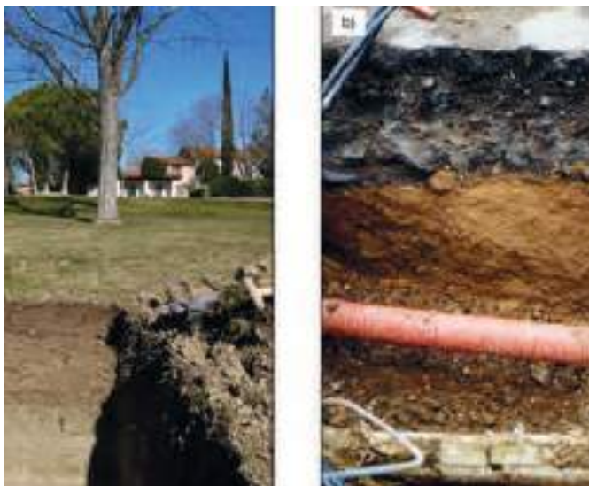
Illustration d'un sol urbain en bon état à gauche et d'un sol compacté et imperméable à droite
